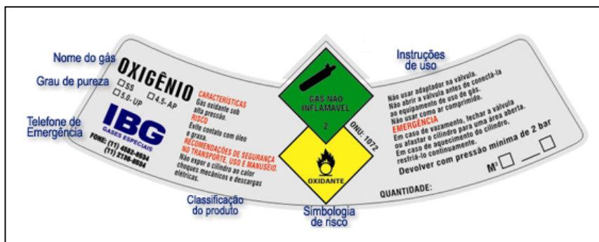
Figura 5.4 Exemplo de um rótulo de gases http://www.oxigenio.com/oxi/dbc/educacional_identificacao_dos_cilindros.htm , acessado em 03/09/2010.
